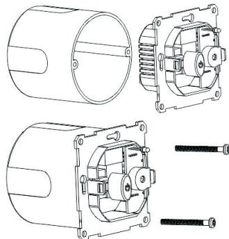
Після монтажу переконайтесь в правильності підключення зовнішнього датчика і напруги мережі. У разі неправильного підключення можливий вихід з ладу терморегулятора.
