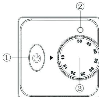
**ПРИМІТКА.** Максимальний струм навантаження реле термостата становить 16 А. Однак, щоб забезпечити максимальний термін служби термостата, рекомендується навантажувати менш ніж 16 А (до 80%).
